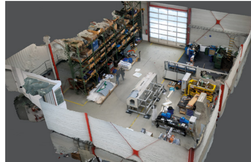
3D-Fabriklayouts lassen sich mit Drohnenhilfe gut erstellen und anschließend mithilfe einer speziellen Software zu einem digitalen Planungsbaukasten aufbereiten
